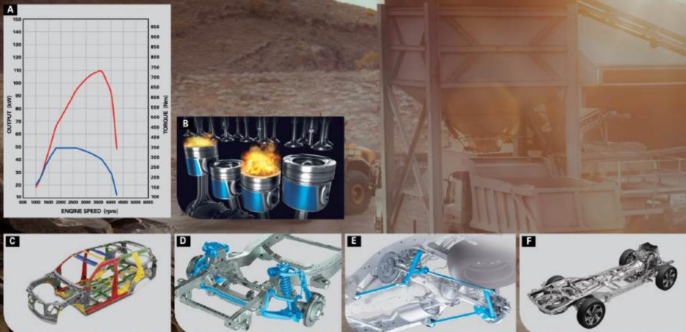
[A] **Hiệu suất động cơ Diesel 1.9L:** Công suất cực đại 110 kW (150 Ps) / Mô-men xoắn cực đại 350 N.m.
